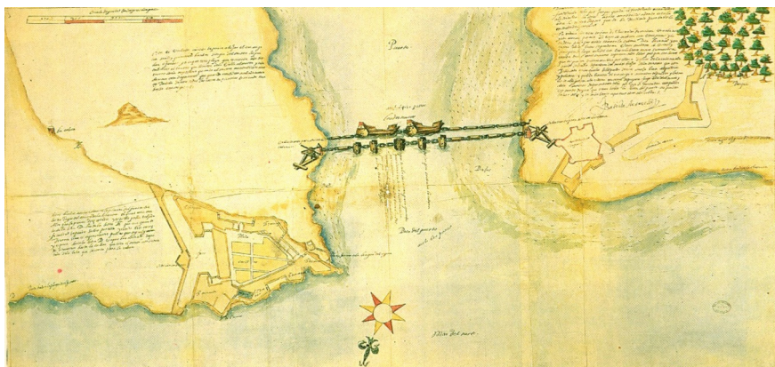
FIG. 7. Battista Antonelli, Traza de la manera como se [h]a de poner la cadena en la entrada del puerto de la Habana, 1591 . Archivo General de Indias, M. y P., Santo Domingo, 12 (México 257).
