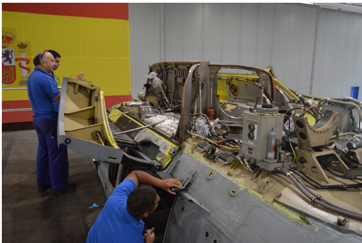
Revisión T/A de un helicóptero HD.21 Superpuma en MAESMA
