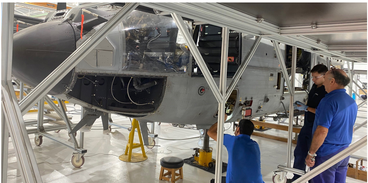
Revisión TA de un helicóptero HD.21 Superpuma en MAESMA
