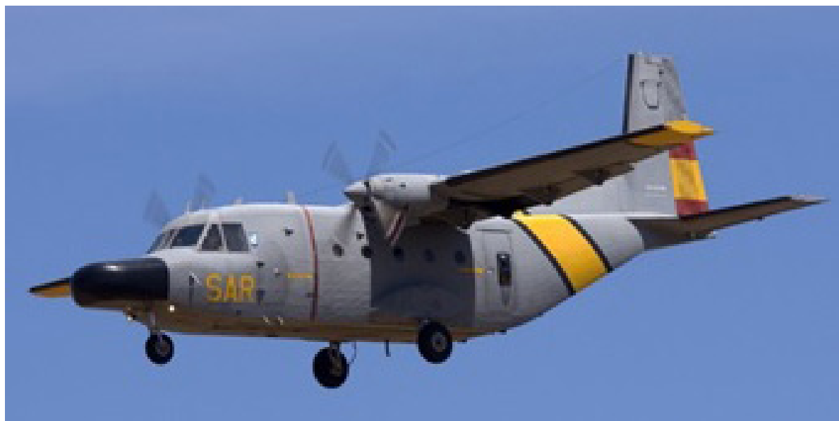
G.63. CASA C-212 Serie 200 Aviocar (D.3). Servicio de búsqueda y rescate en su servicio de SAR y aeronave de guerra electrónica para el extinto Centro de Inteligencia Aérea (CIA) (408 Escuadrón y Ala 47). Revisión y reparación de componentes y mantenimiento en segundo escalón. Fuente: EA
