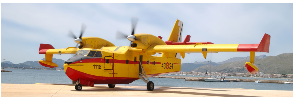
G.71. Canadair CL-215 T. Versión turbohélice. Dado el gran aumento de potencia en comparación con los motores de pistón, se hicieron necesarias notables reformas estructurales y de superficies de vuelo. Revisión y reparación de componentes. Fuente: EA
