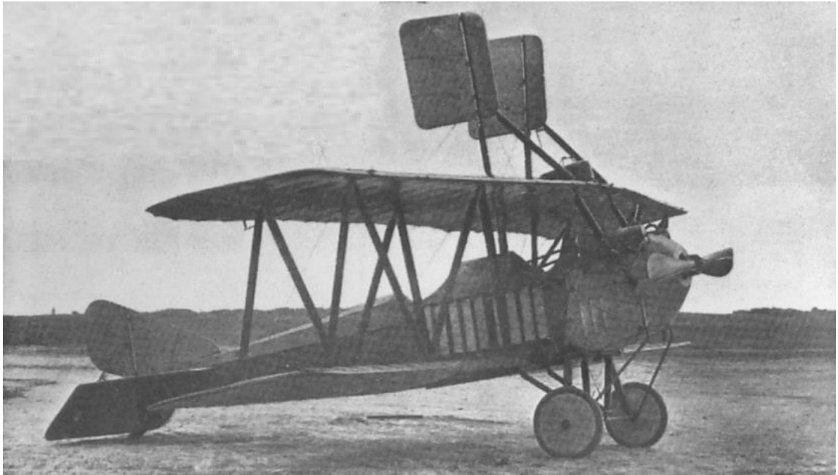
G.16. Barrón Delta «el conejo», avión experimental en servicio desde 20 de julio de 1916. El nombre venía derivado de sus dos grandes alerones verticales sobre el plano superior. Construcción. Fuente: AHEA
