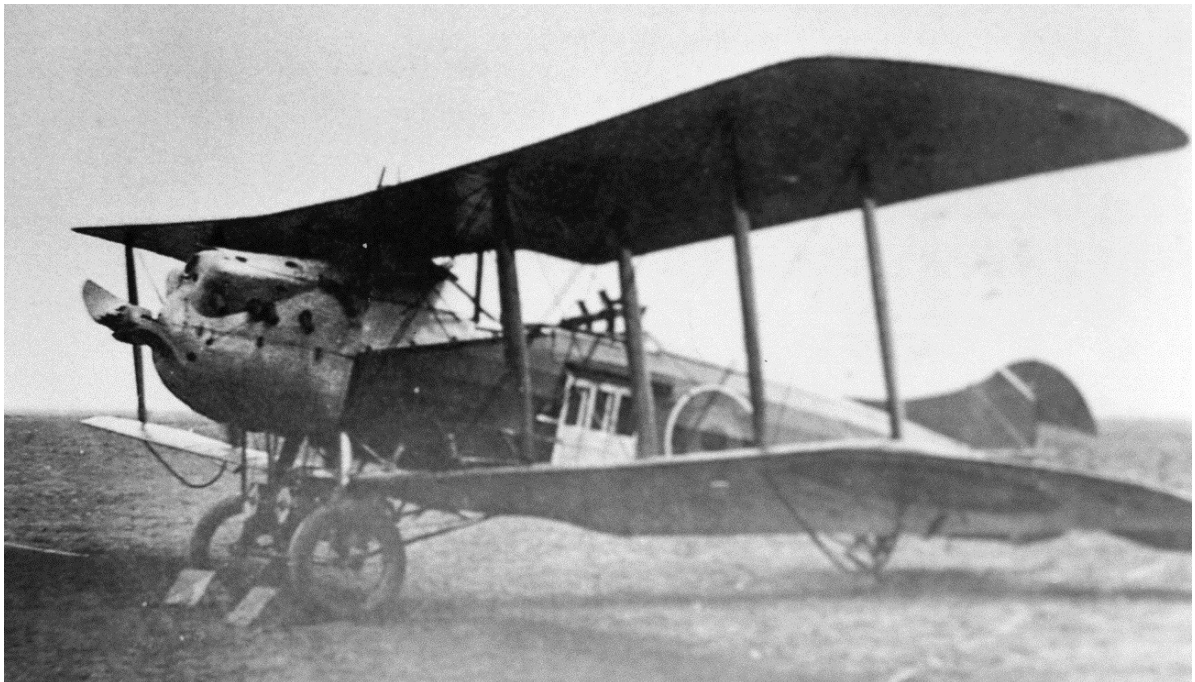
G.36. AME VI versión A1 y A2, prototipo de avión experimental de reconocimiento y bombardeo ligero basado en el Bristol F2B. Desde 1924 a 1927. Construcción y reparación de componentes. Fuente: Wikipedia
