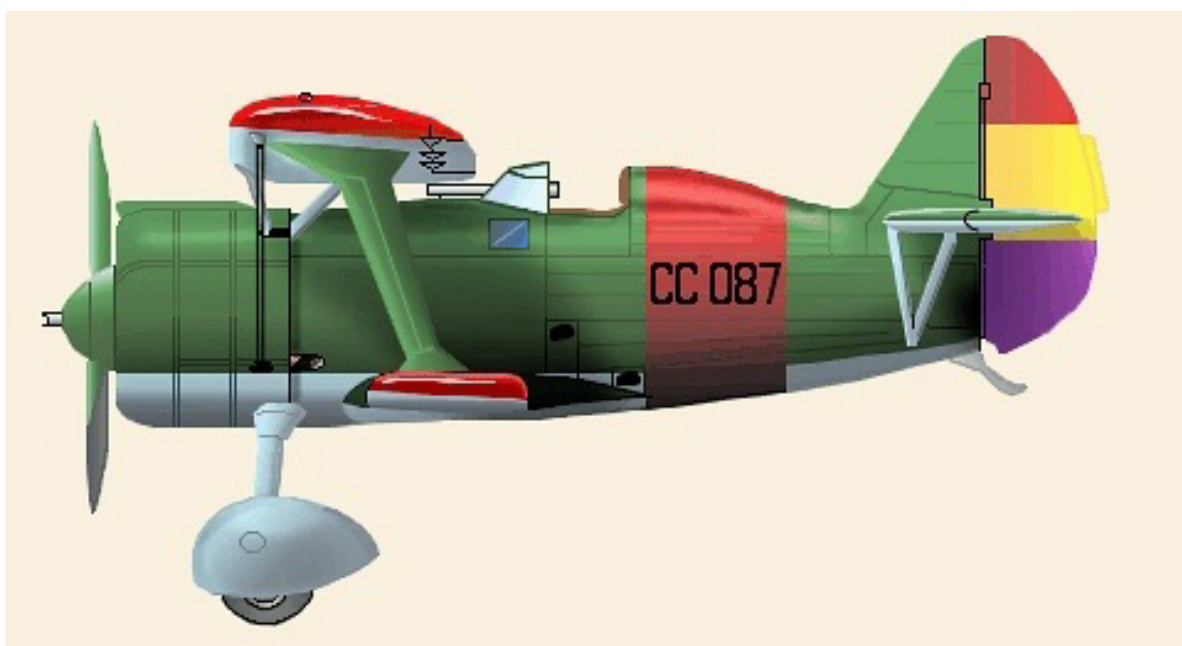
G.46. Polikarpov I-15 Bis «Super Chato». Llevaba un motor radial más potente y tren de aterrizaje rediseñado con las ruedas carenadas. La diferencia principal era el plano superior, con una sección central arriostrada al fuselaje. El borde de ataque del plano superior presentaba un rebaje sobre la cabina abierta del piloto. Revisión y reparación de componentes. Fuente: Historias y máquinas
