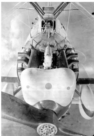
Vista del Hispano Suiza 12Nb en el Cuatro Vientos. Pueden verse el bloque, las dos bancadas de cilindros y los escapes
