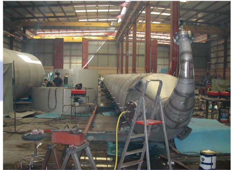
TORRE DE BLANQUEO EN AC. INOX PARA COTTON SOUTH, S.L (FONELAS. GRANADA)
