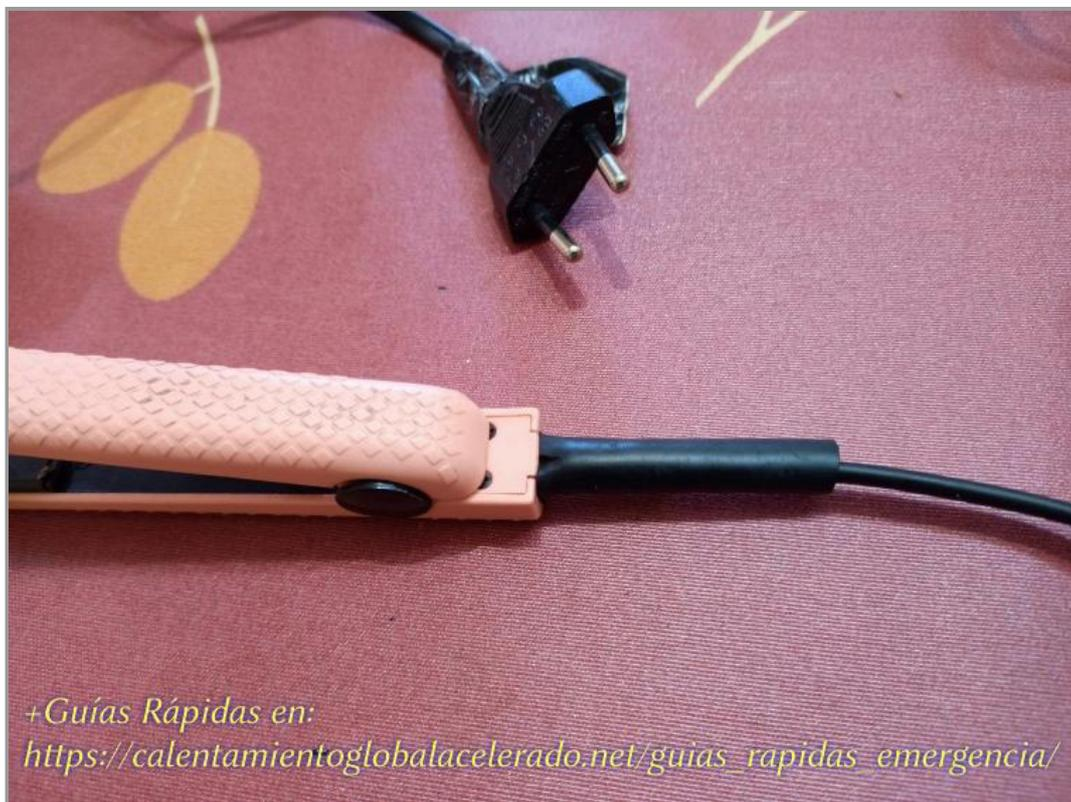
Para ello me serví de un poco de pegamento *SuperGlue Gel* y un con corte longitudinal de cútex en la boca de la funda, pude hacer un pliegue solapado de ésta y conseguir el estrechamiento necesario para abrazar el cable sin dejar holgura. De esta manera conseguimos sellar perfectamente este punto para evitar la entrada de humedad en el interior de la plancha.
