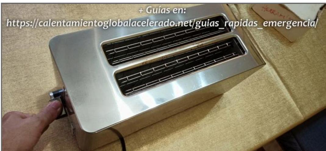
Esta avería consiste en que al presionar el pulsador/palanca hacia abajo para comenzar el tostado, la palanca salta hacia arriba y no se queda retenida, por lo que la tostadora no activa los calentadores. Yo imaginaba que el problema de la retención se producía a veces al introducir rebanadas de pan
