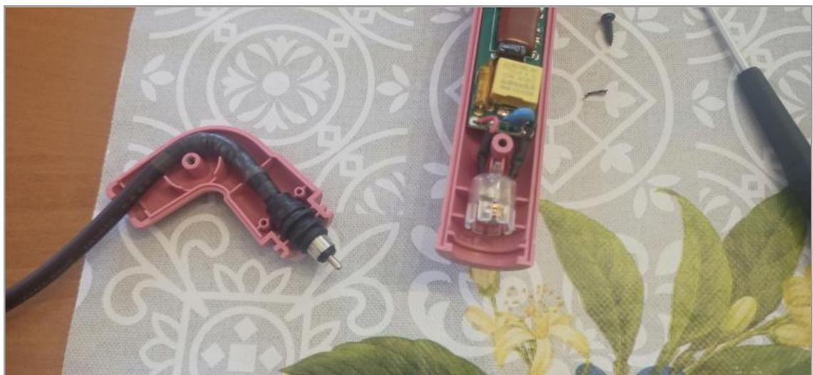
Realizado con éxito este primer ensayo, ahora debemos conseguir de algún modo seguro inmovilizar el cable en la entrada del codo para evitar tensiones y tirones que pueden volver a deteriorar nuestra flamante conexión-empalme a lo largo del tiempo, para ello, y después de trasnochadas elucubraciones, volvemos a servirnos de nuestra vieja aliada, la cinta aislante.
