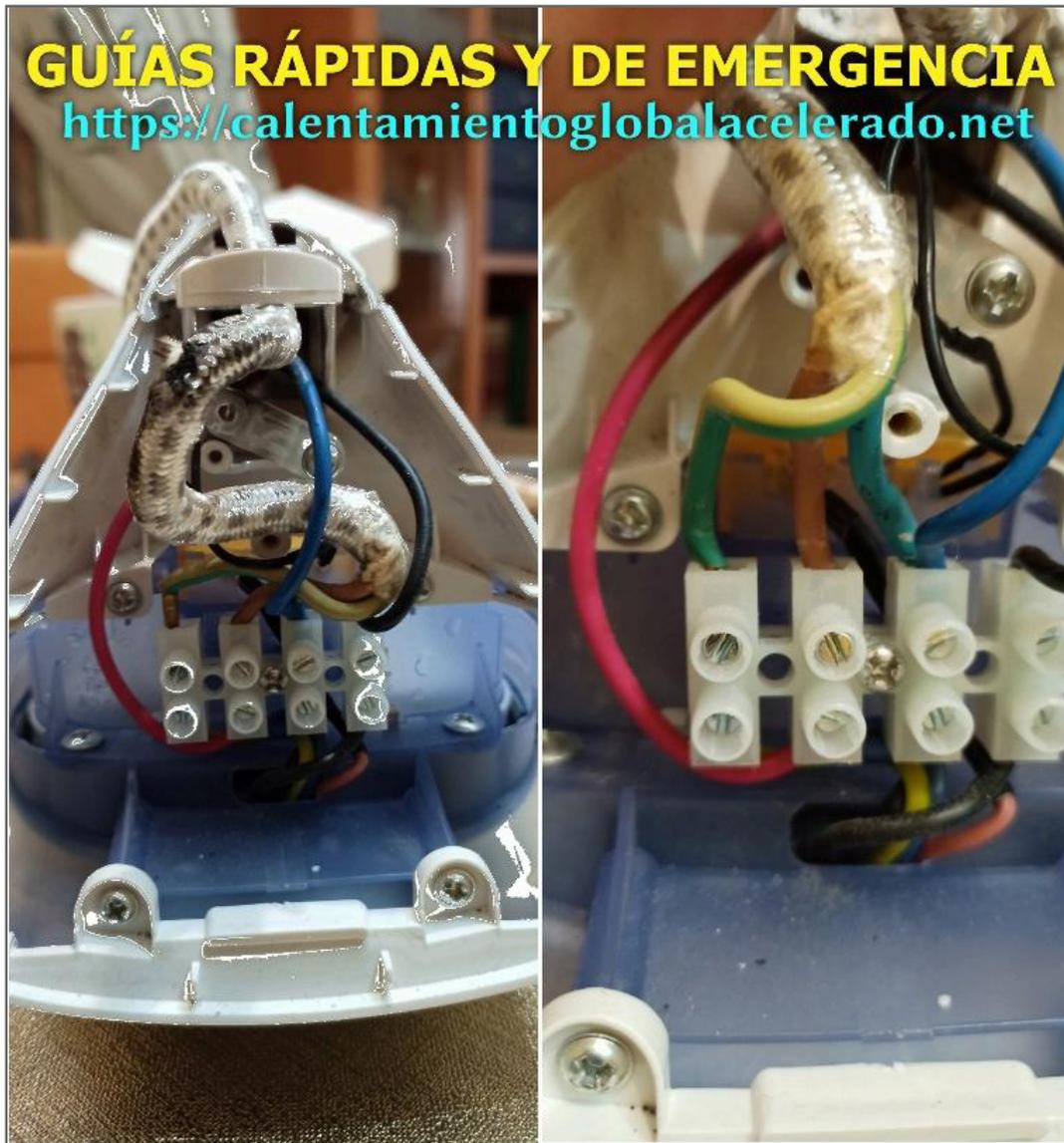
La avería parecía sencilla y todo apuntaba al cable de alimentación, pues aunque parecía estar en perfecto estado al menos en su parte visible, al moverlo provocaba el apagado/encendido de la plancha, algo que podía apreciarse claramente al apagarse y encenderse el testigo de luz (piloto) del aparato.
