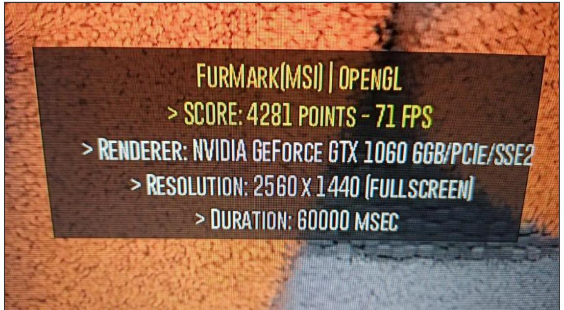
La temperatura de la GPU tras idéntico benchmark (Kombustor bench estándar 1440p) situó el termómetro en unos magníficos **76°C**, exactamente 10°C menos que el obtenido en la prueba pre-intervención, y estabilizándose en 80°C tras 10 minutos de ejecución del benchmark con una carga de GPU del 99%, cuando anteriormente a la limpieza, la temperatura, con idénticos parámetros, había alcanzado los 88-89°C acercándose peligrosamente a los 90°C, probable límite de temperatura antes del apagón.
