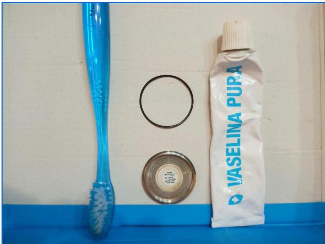
Para la limpieza de la ranura o guía de alojamiento de la junta tanto en el armazón como en la tapa (el rebaje donde se aloja la junta tórica), podemos servirnos de un cepillo de dientes. Si lo has desarmado por que condensa humedad como es mi caso, aprovecha y sopla con un secador de pelo al reloj abierto para eliminar cualquier resto de humedad que pueda quedar en el interior del mecanismo.
