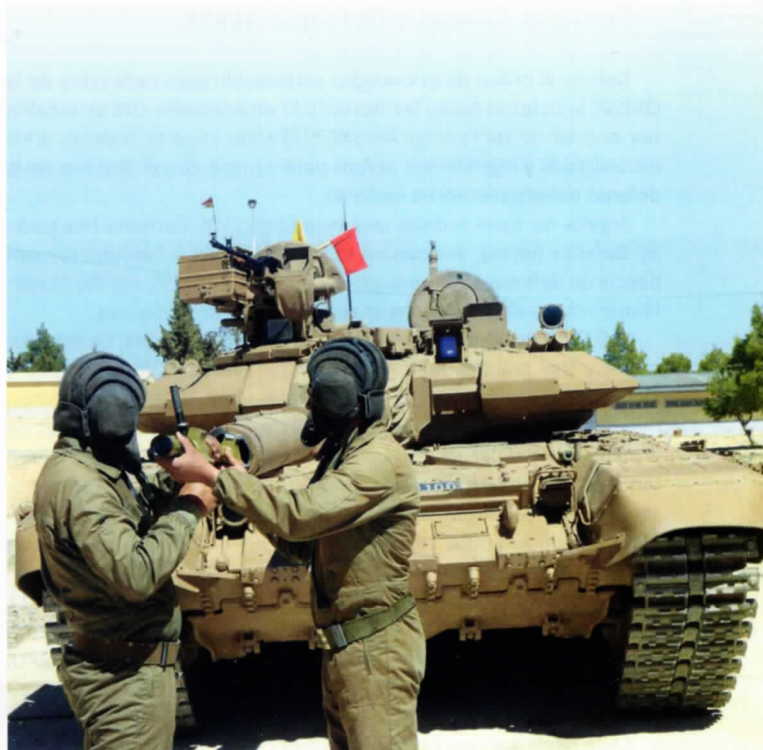
▲ T-90MS argelino mientras dos carristas comprueban el desgaste del cañón a fin de alinearlo correctamente.
